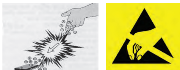
Obr. 4: Princip elektrostatického výboje do součástky a varovný symbol označující citlivost zařízení na elektrostatický výboj
