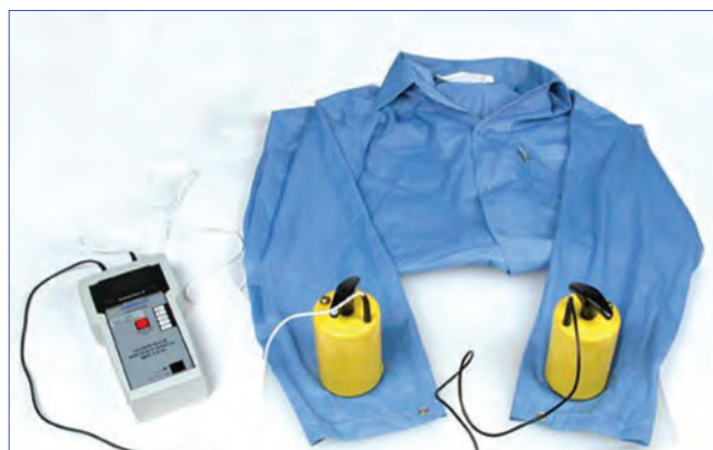
Obr. 15: Příklad měření odporu na oděvu pro ESD pracoviště
