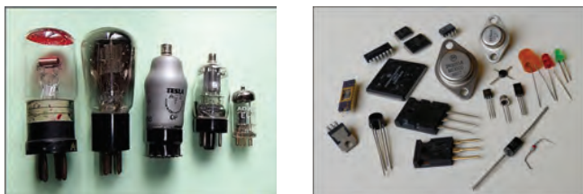
Obr. 2: Vývoj aktivních elektrických součástek. Elektronky (používané cca od roku 1920 do roku 1975) nebyly na vliv elektrostatiky citlivé, u polovodičů je citlivost větší
